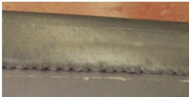
图 2-3 加热器边缘剥离
