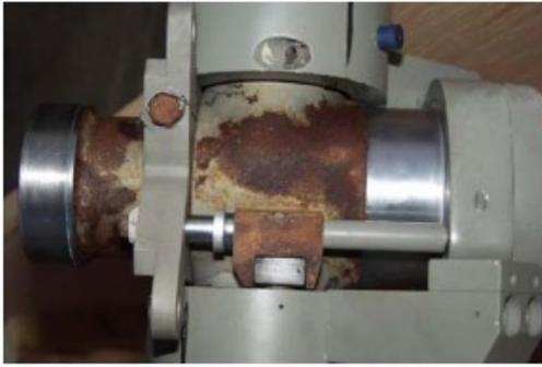
图 1-1 桨毂表面腐蚀
