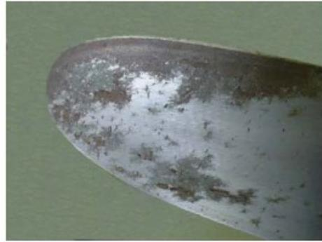
图 1-2 抛光桨叶表面腐蚀
