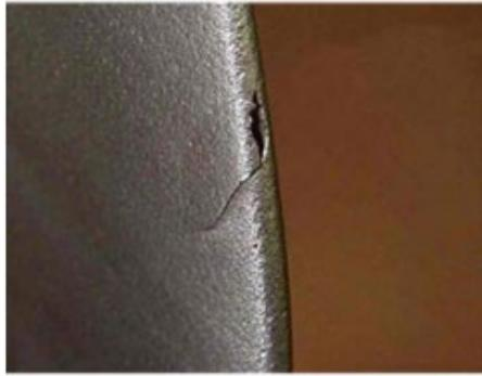
图 2-4 护套裂纹
