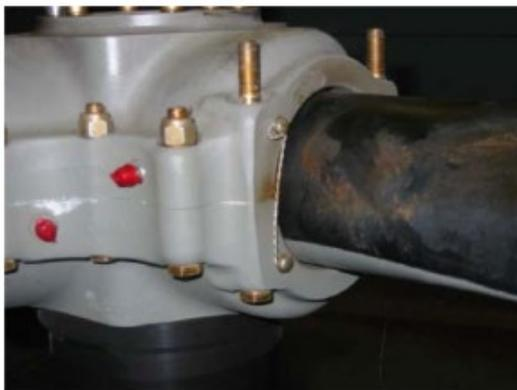
图 2-1 油脂泄漏残留物
