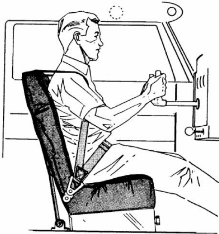
9-12.典型地板固定式卷收器的安装
